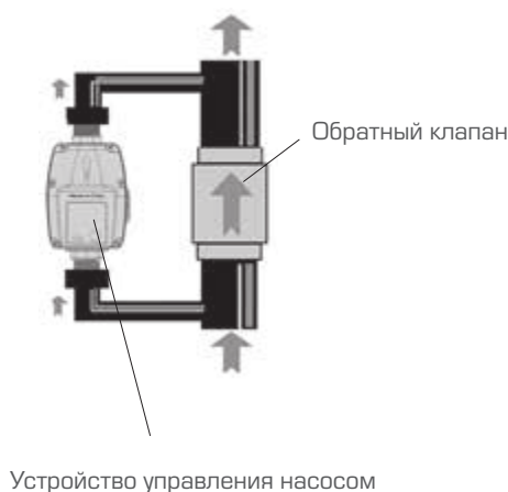
Рис. 43. Установка устройства управления насосом при большом расходе воды в системе
