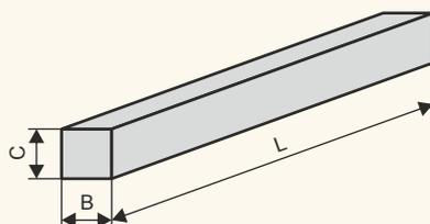
Для плоского и круглого наружного шлифования, хонингования деталей из различных марок сталей, заточки и правки режущего инструмента.
