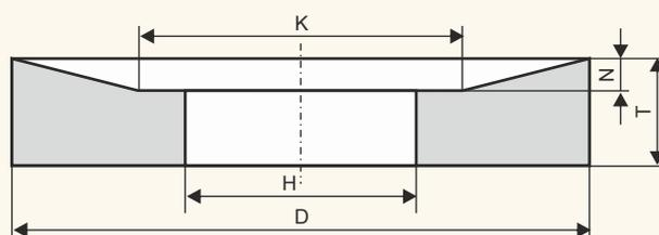
Для всех видов шлифования с возможностью одновременной обработки торцом и периферией круга деталей и конструкций из различных марок сталей, заточки режущего инструмента из быстрорежущих сталей.
