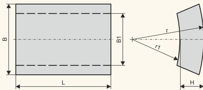
Для плоского шлифования деталей и конструкций из различных марок сталей.
