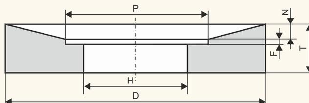
Для всех видов шлифования с возможностью одновременной обработки торцом и периферией круга деталей и конструкций из различных марок сталей, заточки режущего инструмента из быстрорежущих сталей.
