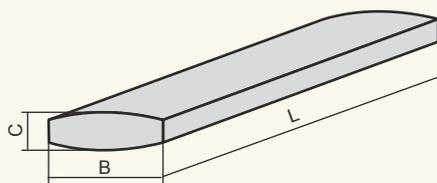
Для окончательной правки и заточки режущего инструмента, подсочных резцов.
