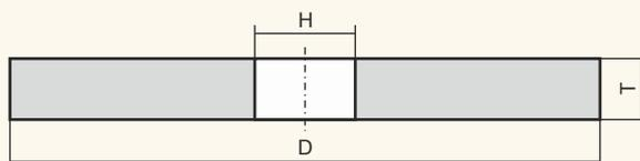
Для всех видов шлифования деталей и конструкций из чугуна, цветных металлов, природного и искусственного камня, стекла, фарфора, заточки твердосплавного режущего инструмента, правки шлифовальных кругов.
