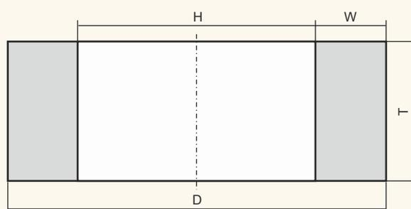
Для плоского шлифования торцом круга деталей и конструкций из различных марок сталей, а также для заточки режущего инструмента из быстрорежущих сталей.
