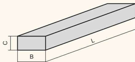
Для плоского и круглого наружного шлифования, хонингования деталей из различных марок сталей, заточки и правки режущего инструмента.
