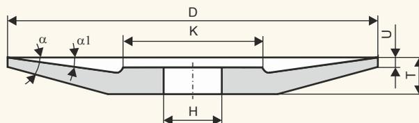
Для прорезки канавок в деталях и конструкциях из различных марок сталей, заточки режущего инструмента из быстрорежущих сталей.
