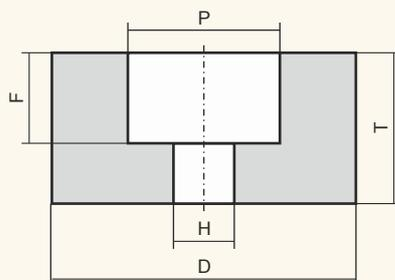
Для всех видов шлифования деталей и конструкций из различных марок сталей, заточки режущего инструмента из быстрорежущих сталей.
