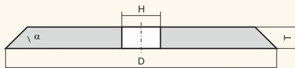
Для заточки зубьев продольных и дисковых пил из инструментальных сталей, шлицевшлифования, зубошлифования, заточки режущего инструмента из быстрорежущих сталей.
