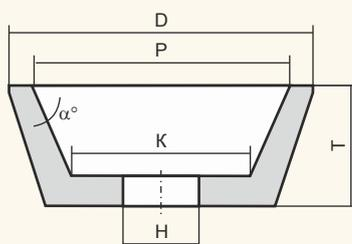
Для операций плоского шлифования и шлице-шлифования деталей и конструкций из чугуна, цветных металлов, природного и искусственного камня, стекла, фарфора, заточки твердосплавного режущего инструмента.
