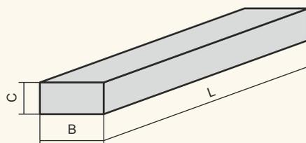
Для плоского и круглого наружного шлифования, хонингования деталей из различных марок сталей, заточки и правки режущего инструмента.
