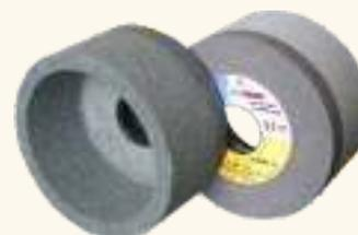
Для операций плоского, круглого внутреннего шлифования деталей и конструкций из чугуна, цветных металлов, природного и искусственного камня, стекла, заточки твердосплавного режущего инструмента.
