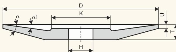
Для прорезки канавок в деталях и конструкциях из чугуна, цветных металлов, природного и искусственного камня, стекла, фарфора, заточки режущего твердосплавного инструмента.
