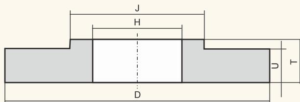
Для плоского шлифования торцом круга деталей и конструкций из различных марок сталей.
