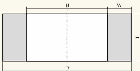
Для плоского шлифования торцом круга деталей и конструкций из чугуна, цветных металлов и минеральных материалов.
