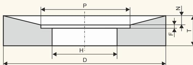
Для всех видов шлифования с возможностью одновременной обработки торцом и периферией круга деталей и конструкций из чугуна, цветных металлов, природного и искусственного камня, стекла, фарфора, заточки твердосплавного режущего инструмента.
