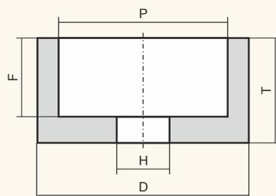
Для операций плоского и круглого внутреннего шлифования деталей и конструкций из различных марок сталей, заточки режущего инструмента из быстрорежущих сталей.
