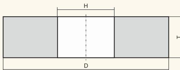
Для плоского шлифования торцом круга деталей и конструкций из различных марок сталей, для заточки режущего инструмента.
