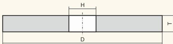
Для всех видов шлифования деталей и конструкций из различных марок сталей, а также для заточки режущего инструмента из быстрорежущих сталей.
