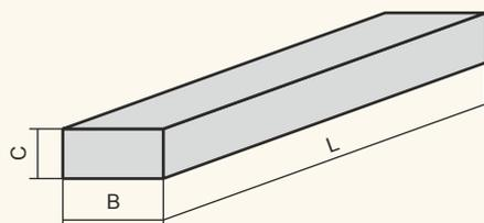
Для плоского и круглого наружного шлифования, хонингования деталей из чугуна, цветных металлов, природного и искусственного камня, стекла, фарфора, заточки и правки режущего инструмента.
