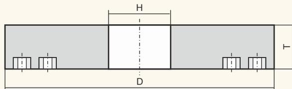
Для плоского шлифования торцом круга деталей и конструкций из различных марок сталей.
