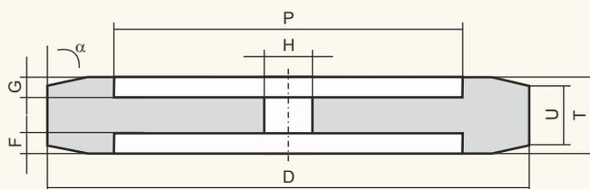
Для операций шлифования деталей и конструкций из различных марок сталей, заточки режущего инструмента из быстрорежущих сталей.
