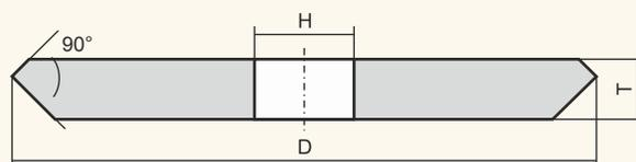
Для шлифования деталей и конструкций из различных марок сталей.
