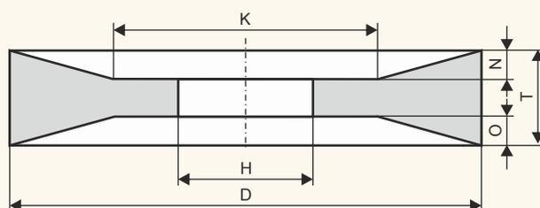
Для всех видов шлифования с возможностью одновременной обработки торцом и периферией круга деталей и конструкций из различных марок сталей, заточки режущего инструмента из быстрорежущих сталей.
