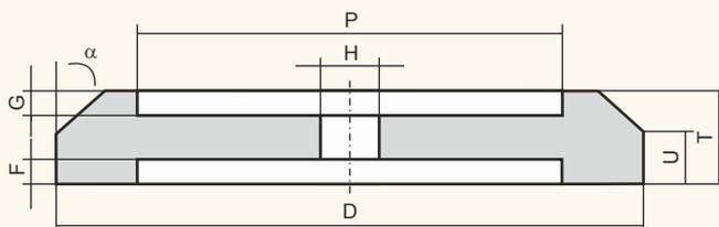
Для операций шелушения круп, шлифования деталей и конструкций из различных марок сталей, заточки режущего инструмента из быстрорежущих сталей.
