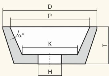
Для плоского шлифования деталей и конструкций из различных марок сталей, шлицшлифования, заточки режущего инструмента из быстрорежущих сталей.
