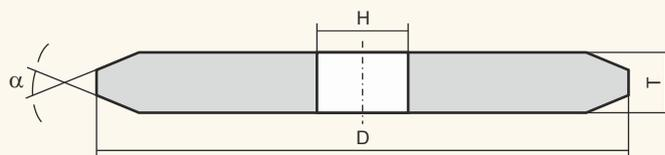
Для зубошлифования, резьбошлифования деталей из различных марок сталей, заточки режущего инструмента из быстрорежущих сталей.
