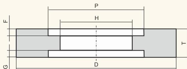
Для операций плоского, круглого наружного и внутреннего шлифования деталей и конструкций из различных марок сталей, заточки режущего инструмента из быстрорежущих сталей, шелушения круп.
