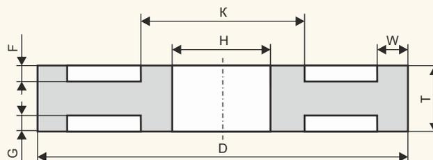
Для операций плоского, круглого наружного шлифования деталей и конструкций из различных марок сталей.
