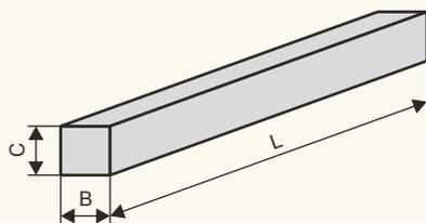
Для плоского и круглого наружного шлифования, хонингования деталей из чугуна, цветных металлов, природного и искусственного камня, стекла, фарфора, заточки и правки режущего инструмента.
