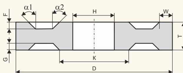
Для операций плоского, круглого наружного шлифования деталей и конструкций из различных марок сталей.
