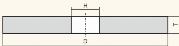
Для всех видов шлифования деталей и конструкций из чугуна, цветных металлов, природного и искусственного камня, стекла, фарфора, заточки твердосплавного режущего инструмента, правки шлифовальных кругов.
