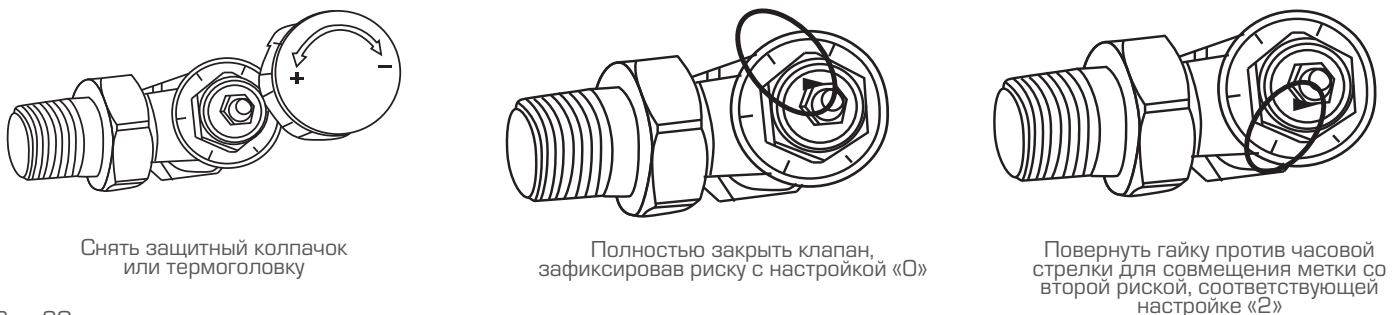
Рис. 20. Пример преднастройки клапана терморегулятора
