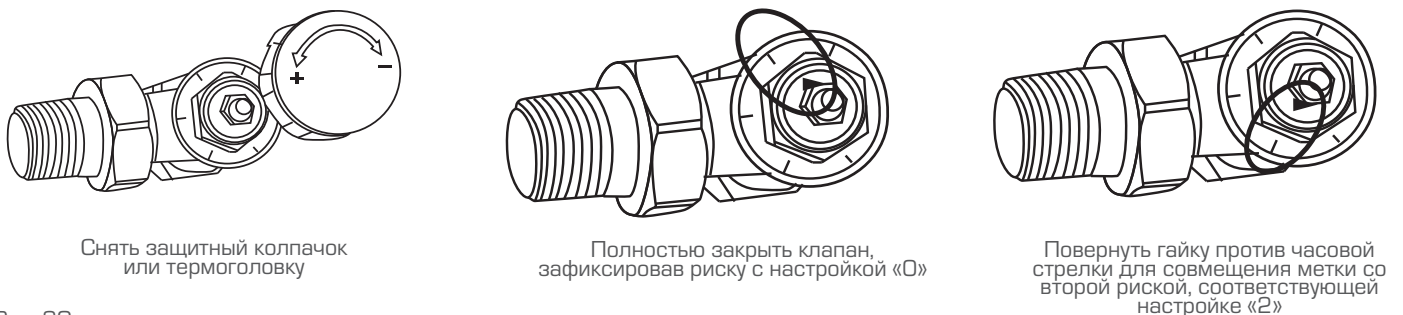
Рис. 20. Пример преднастройки клапана терморегулятора
