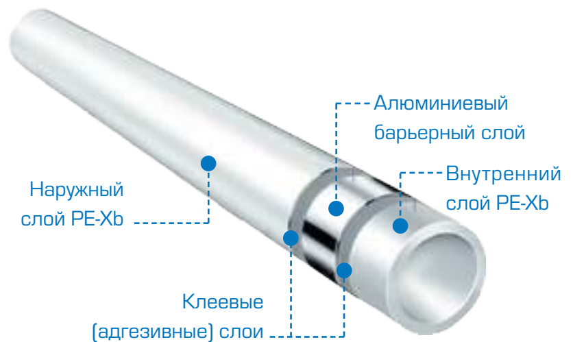
Рис. 5. Пятислойная металлополимерная труба PE-Xb/Al/PE-Xb
