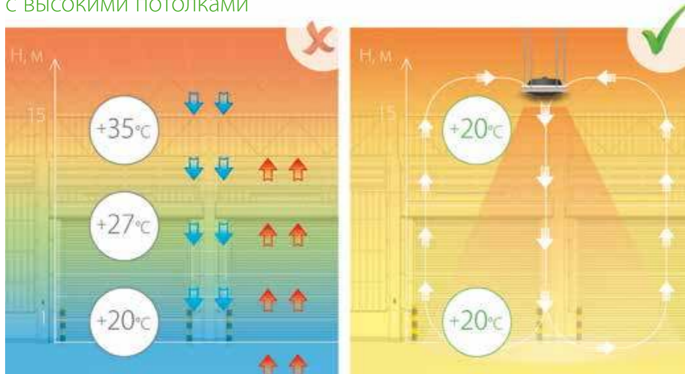
Распределение тепла в здании без использования дестратификаторов
