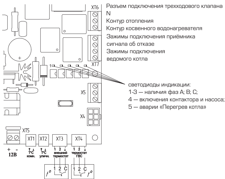
Рис. 5. Расположение разъемов на плате контроллера
