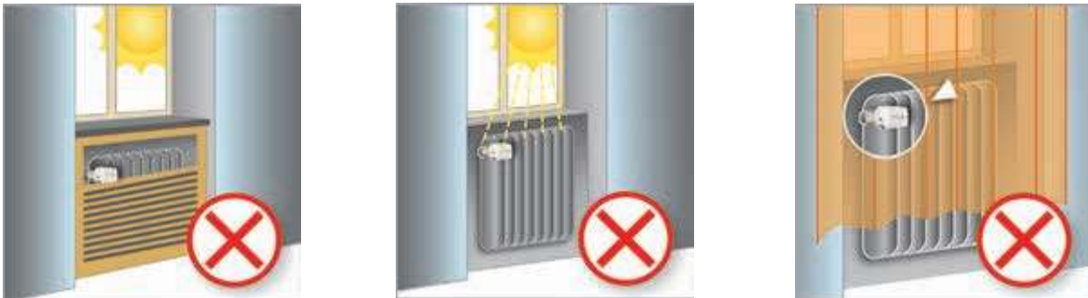
Рис. 8. Требования по размещению автоматического терморегулятора
