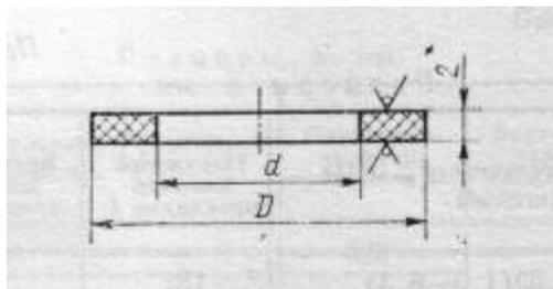
\*Для Ду 1400 мм и более толщина прокладки 3мм
