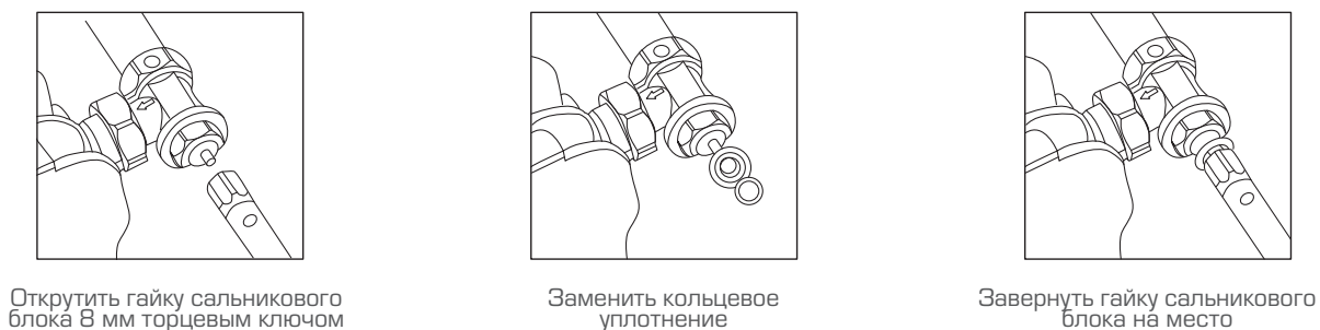
Рис. 21. Замена кольцевого уплотнения штока клапана терморегулятора
