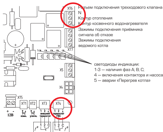
Рис. 13. Схема подключения датчика температуры бойлера
