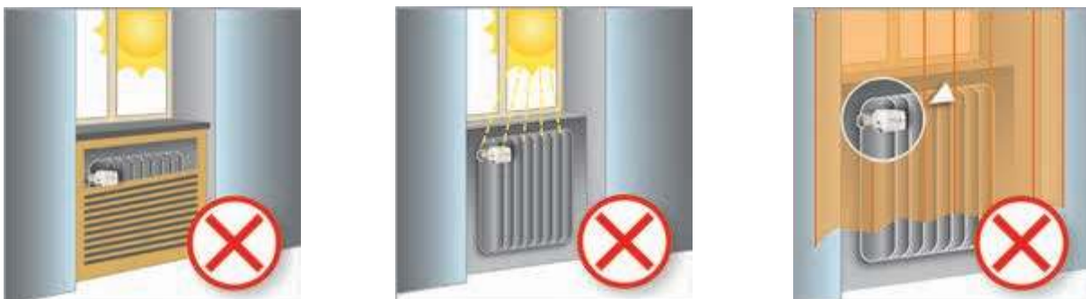
Рис. 8. Требования по размещению автоматического терморегулятора
