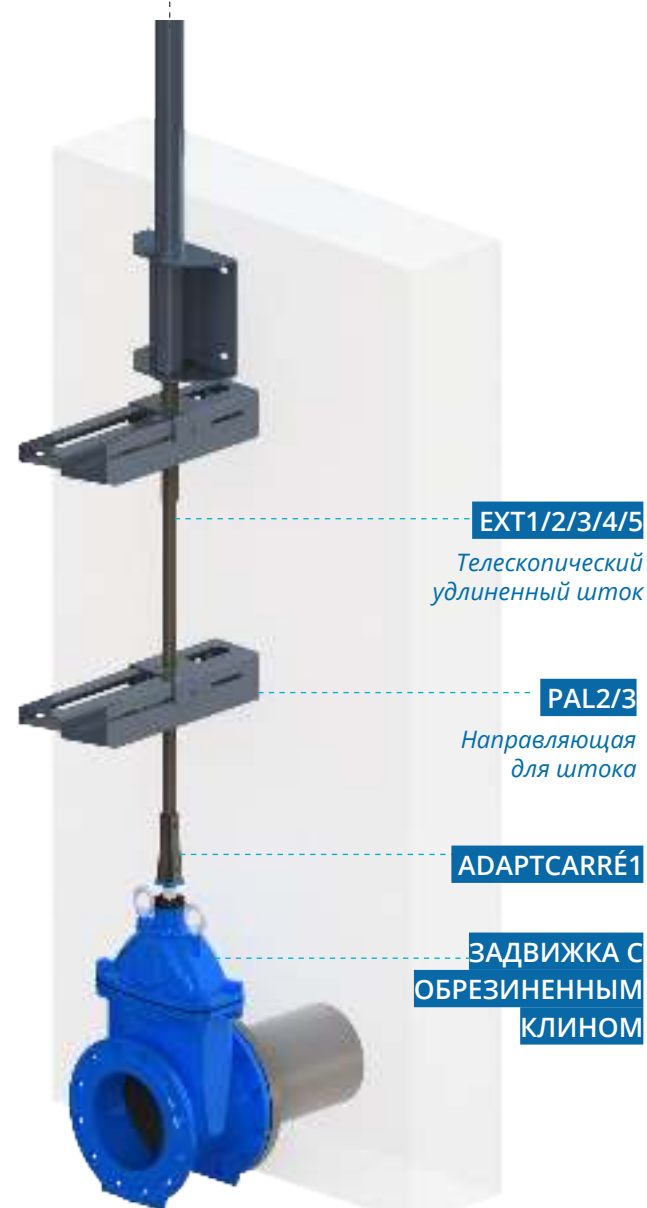
Монтаж на задвижку VOC4241C-051
