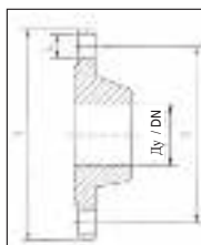
Фланец тип 11B согласно стандарта DIN 2632 For flange type 11B standard DIN 2632
