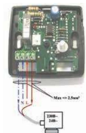
Рис. 13. Схемы электрических соединений термостата
