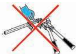
При изготовлении соединения не следует прикасаться к зоне запрессовки
