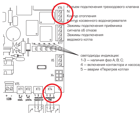
Рис. 13. Схема подключения датчика температуры бойлера
