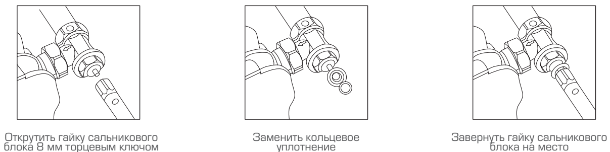
Рис. 21. Замена кольцевого уплотнения штока клапана терморегулятора
