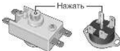
Рисунок 2. Возможные схемы расположения кнопки термовыключателя
