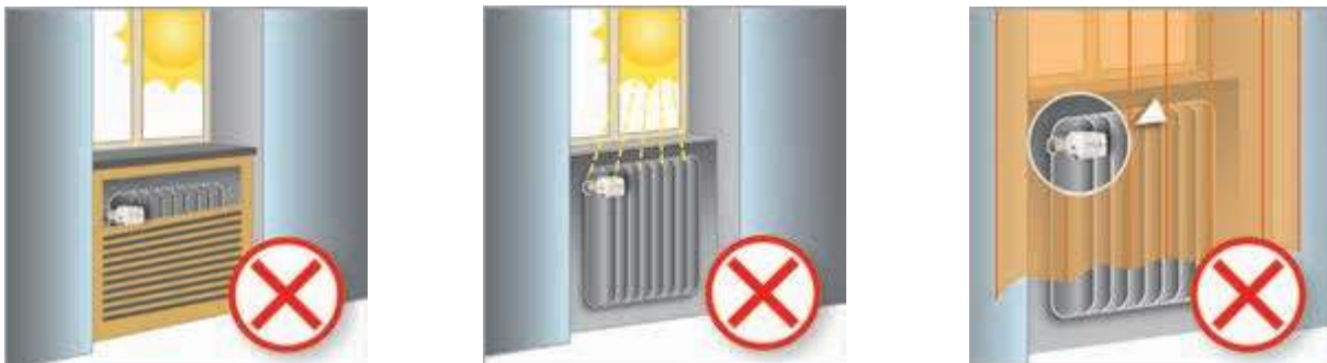
Рис. 8. Требования по размещению автоматического терморегулятора
