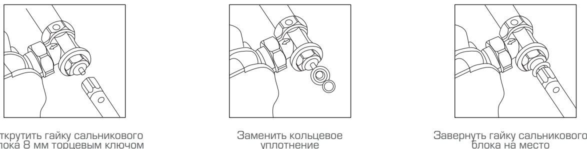
Рис. 21. Замена кольцевого уплотнения штока клапана терморегулятора
