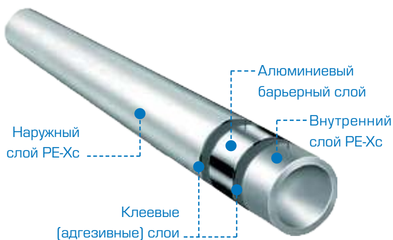
Рис. 2. Пятислойная труба PE-Xc/Al/PE-Xc
