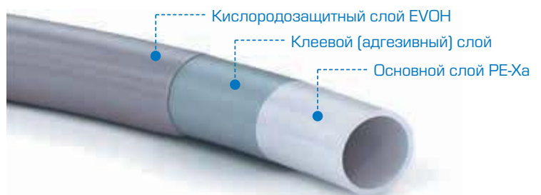
Рис. 1. Трехслойная труба РЕ-Ха/EVOH
