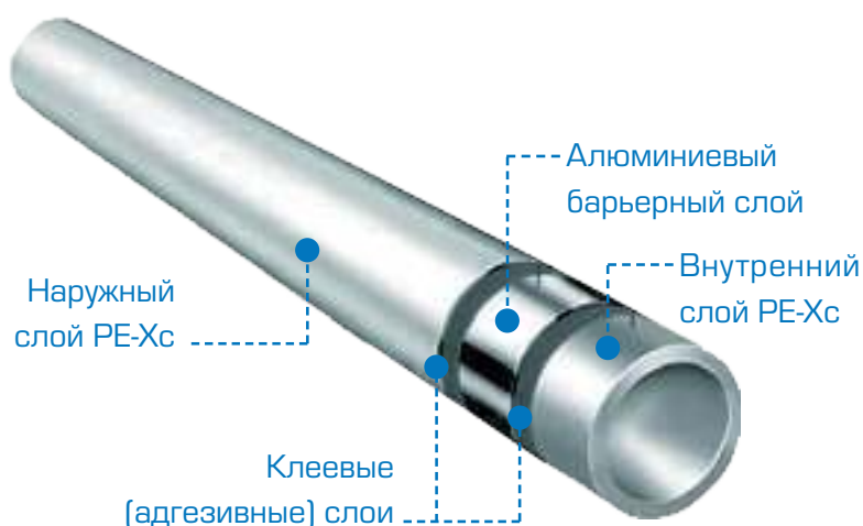
Рис. 2. Пятислойная труба PE-Xc/Al/PE-Xc
