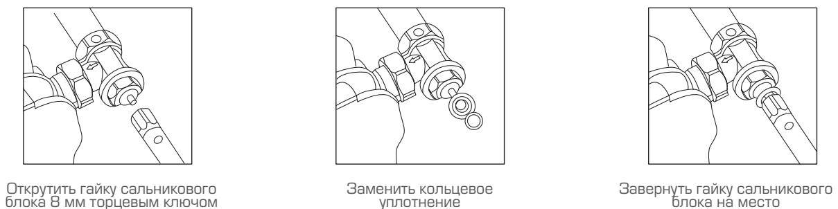
Рис. 21. Замена кольцевого уплотнения штока клапана терморегулятора
