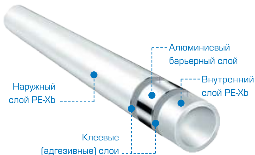
Рис. 5. Пятислойная металлополимерная труба PE-Xb/Al/PE-Xb
