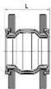
Габаритные размеры гибкой вставки типа ZKV.
