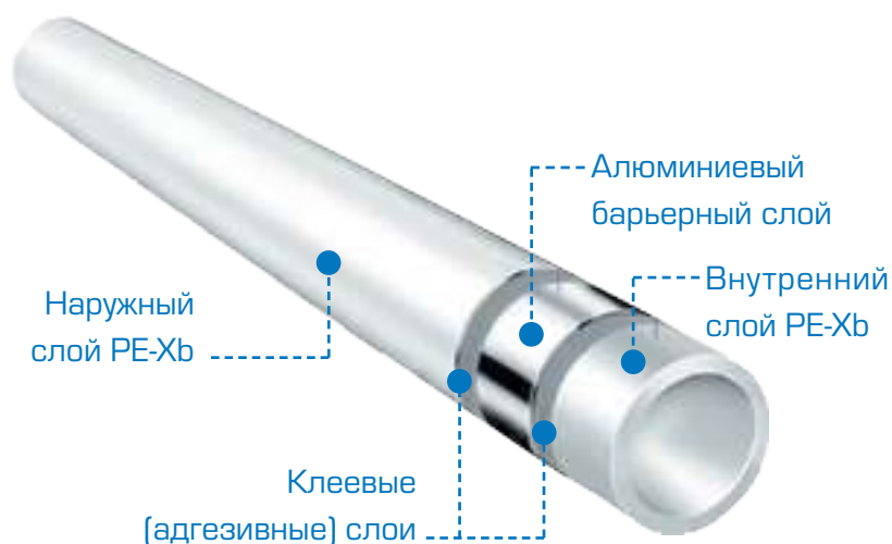
Рис. 5. Пятислойная металлополимерная труба PE-Xb/Al/PE-Xb
