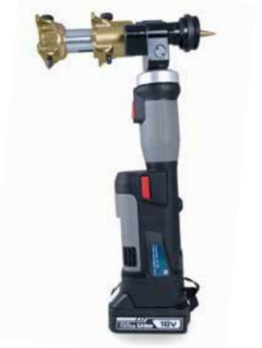
Аккумуляторный многофункциональный инструмент PRO AQUA AX.BTOOL1632C предназначен для работы с трубами PE-X и PE-RT серии S3.2 (SDR 7.4) с диаметрами 16, 20, 25 и 32 мм. Он питается от литий-ионного аккумулятора, приводится в действие электродвигателем и управляется микроконтроллером. Благодаря встроенной гидравлической системе высокого давления инструмент экономит ваши силы и уменьшает время монтажа.
