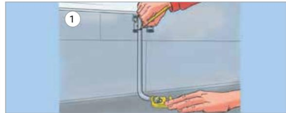
Отмерить длину присоединительной трубки, учитывая при этом то, что трубка должна быть вставлена в евроконус до упора.
