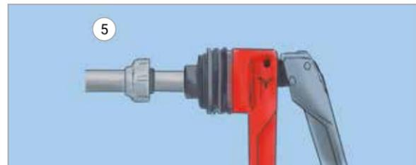
Вставить расширительную насадку (размер 15 x 1,0) внутрь присоединительной трубки и произвести развальцовку.
