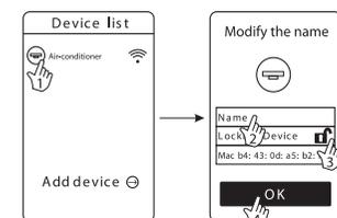
Если у вас заблокированное устройство, вы должны разблокировать устройство прежде чем подключать другие телефоны. Если моб.телефон, с которого было заблокировано устройство пропал, Вы должны перезагрузить Wi-Fi модуль, только после этого вы можете использовать новый моб.телефон для соединения с устройством.
