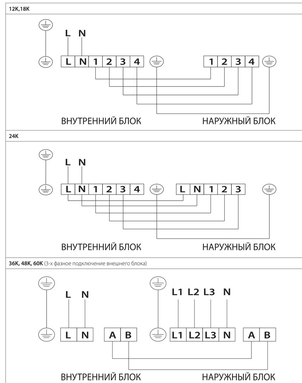
4.2. СХЕМЫ ЭЛЕКТРИЧЕСКИХ СОЕДИНЕНИЙ ВНУТРЕННИХ БЛОКОВ:
