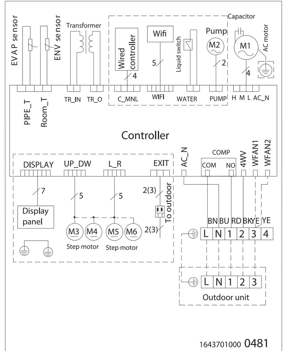
4.2.3. 36K, 48K, 60K (3 фазы): кассетного типа, напольно-потолочного, канального
