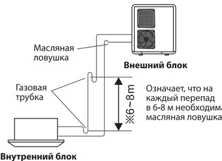
Эта схема предназначена для пояснения. Фактическая установка будет отличаться от этой в зависимости от условий на месте. При изготовлении масляной ловушки радиус изгиба должен быть в 1,5-2 раза больше диаметра трубы.
