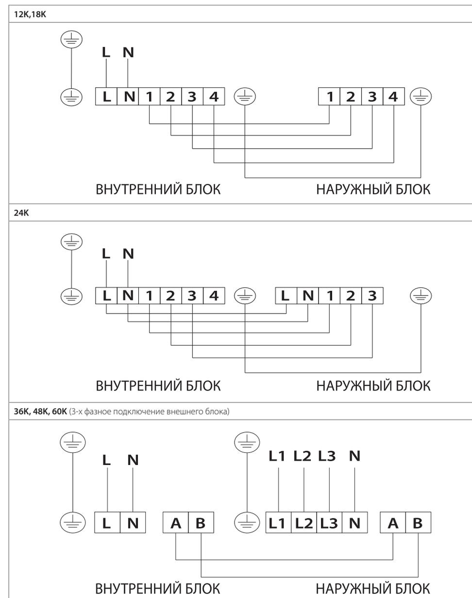
4.2. СХЕМЫ ЭЛЕКТРИЧЕСКИХ СОЕДИНЕНИЙ ВНУТРЕННИХ БЛОКОВ:
