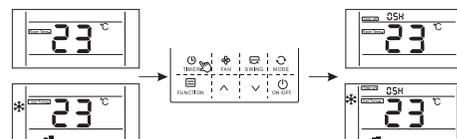
После входа в интерфейс установки времени время по умолчанию составляет 0,5 часов, в этот момент нажмите кнопку «^» или «v», чтобы отрегулировать время. Если кнопка не будет нажата в течение 10 секунд, настройка синхронизации будет отменена, а затем вернется в состояние отсутствия синхронизации.
