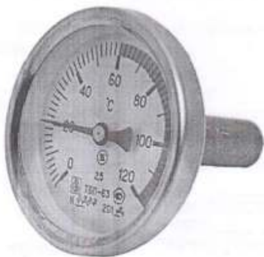
Рисунок 1 – Термометр биметаллический показывающий ТБП63 (исполнение 1)
