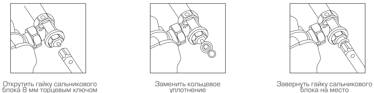
Рис. 21. Замена кольцевого уплотнения штока клапана терморегулятора
