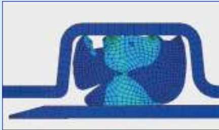
Рисунок 12. Упругие деформации однолепесткового уплотнительного кольца в раструбе
