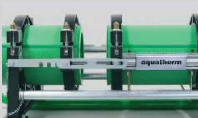
Трубы развести, удалить нагревательный элемент
