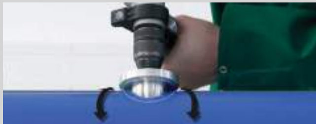
Снятие кислородонепроницаемого слоя с трубы aquatherm blue pipe OT
