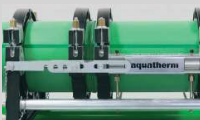
Трубы свести под давлением дать соединению остыть
