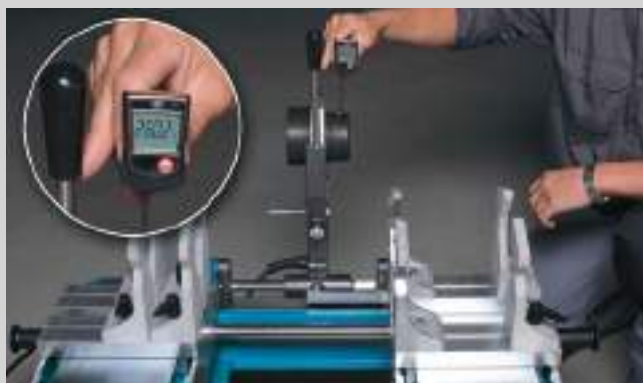
Измерение температуры на сварочной машине aquatherm
