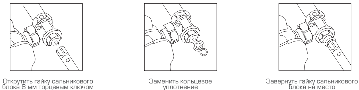
Рис. 21. Замена кольцевого уплотнения штока клапана терморегулятора
