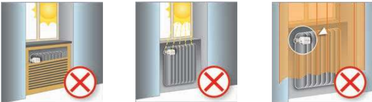
Рис. 8. Требования по размещению автоматического терморегулятора
