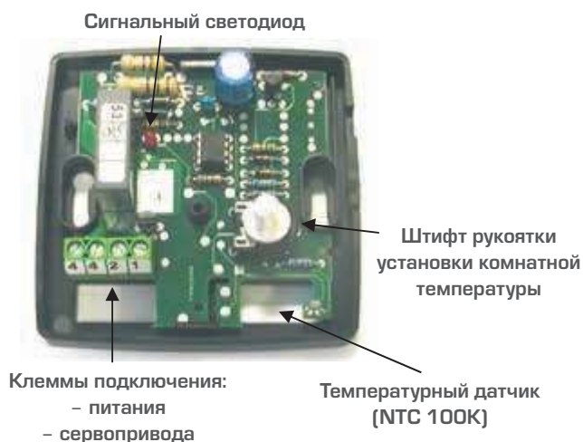
Рис. 12. Устройство электронного термостата для напольного отопления
