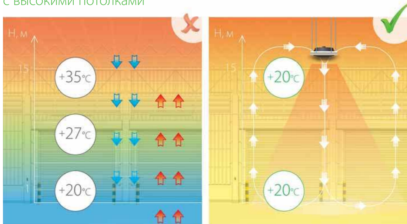
Распределение тепла в здании без использования дестратификаторов
