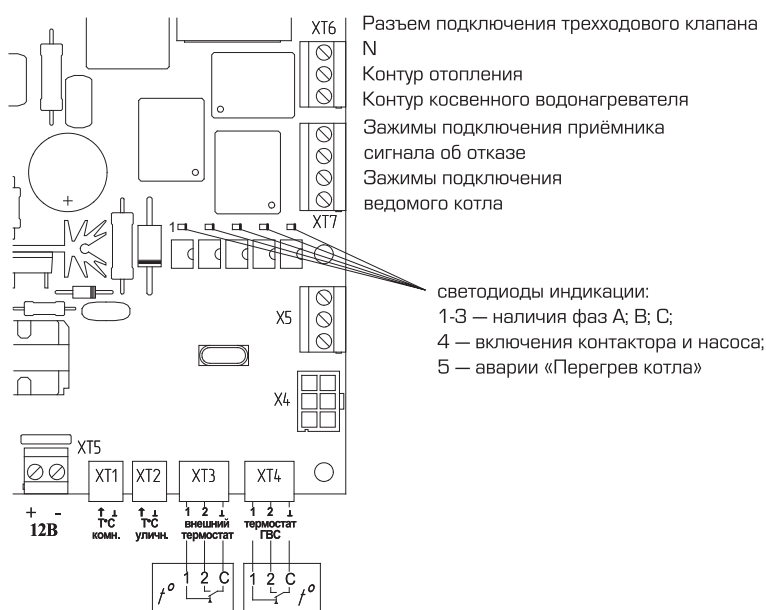
Рис. 5. Расположение разъемов на плате контроллера
