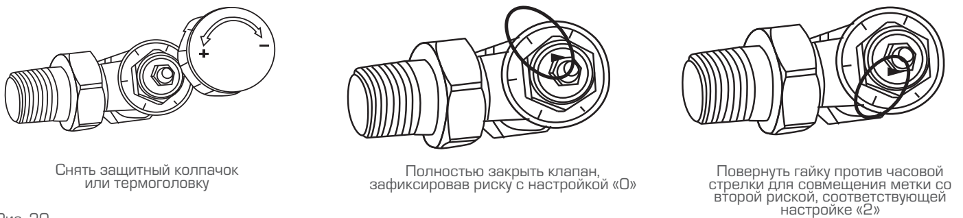
Рис. 20. Пример преднастройки клапана терморегулятора
