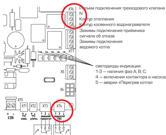
Рис. 13. Схема подключения датчика температуры бойлера
