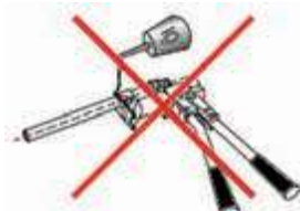
Трубу следует защищать от попадания на нее масел и не применять смазки при выполнении соединения с использованием надвижной гильзы
