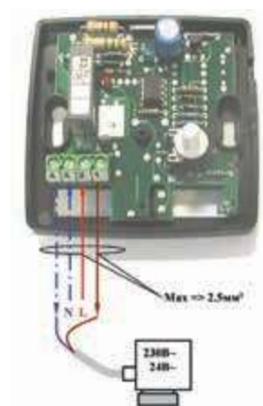
Рис. 13. Схемы электрических соединений термостата
