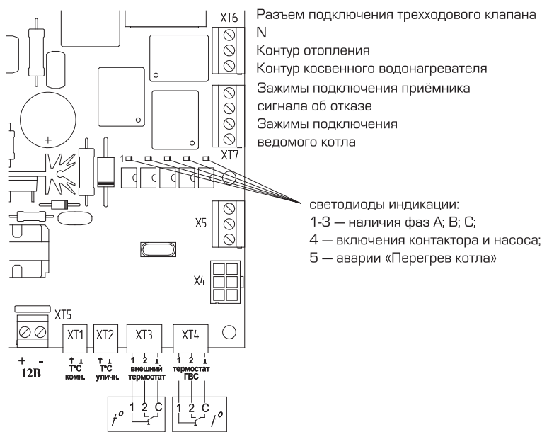
Рис. 5. Расположение разъемов на плате контроллера
