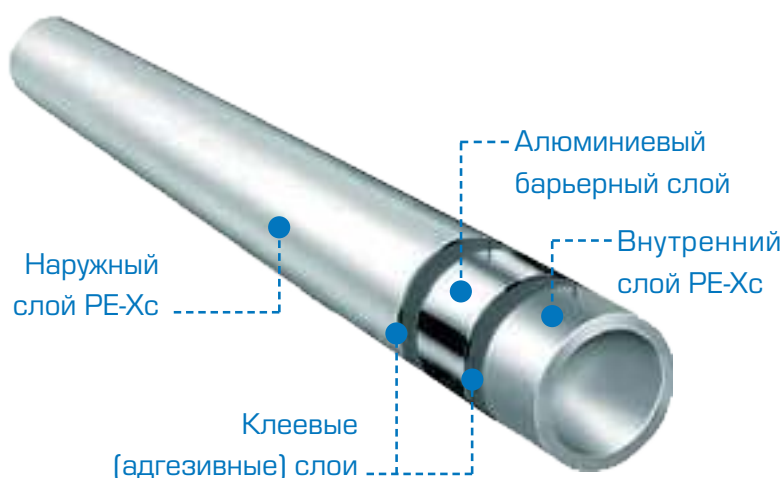
Рис. 2. Пятислойная труба PE-Xc/Al/PE-Xc
