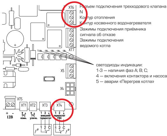
Рис. 13. Схема подключения датчика температуры бойлера
