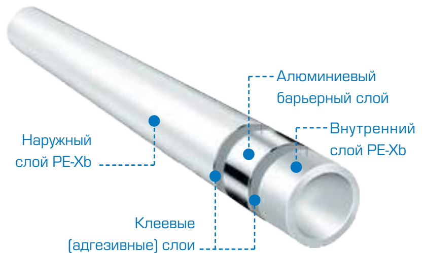
Рис. 5. Пятислойная металлополимерная труба PE-Xb/Al/PE-Xb
