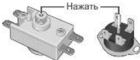
Рисунок 3. Возможные схемы расположения кнопки термовыключателя
