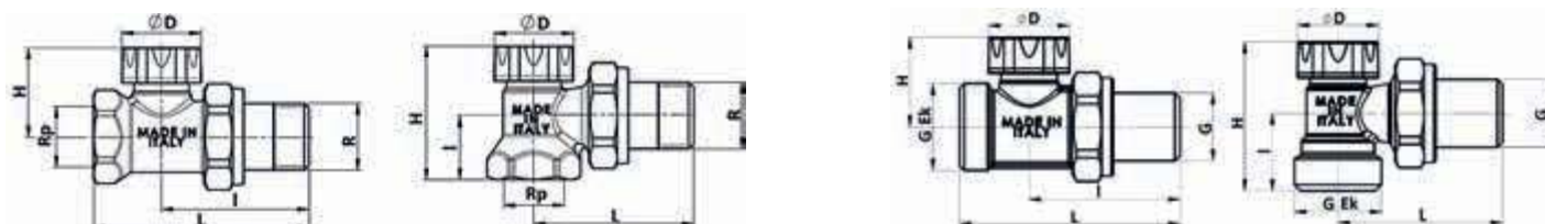
Рис. 31. Устройство запорно-балансировочного клапана типа SVL
