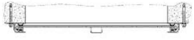
Установка в существующем канале (тип FM)
