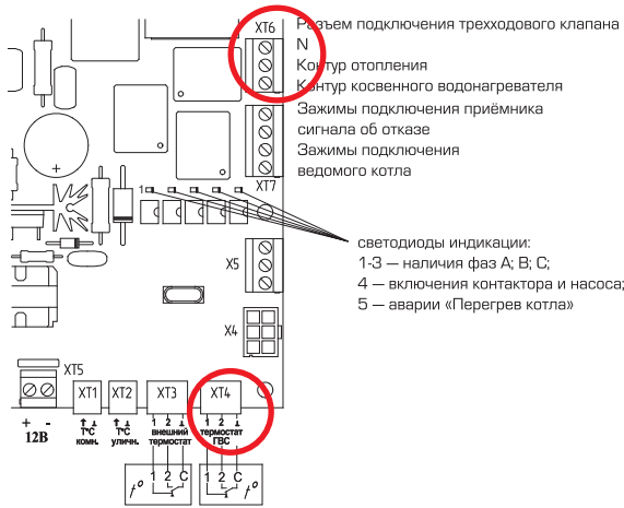
Рис. 13. Схема подключения датчика температуры бойлера
