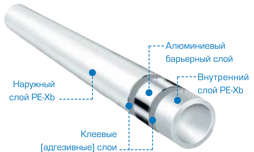
Рис. 5. Пятислойная металлополимерная труба PE-Xb/Al/PE-Xb
