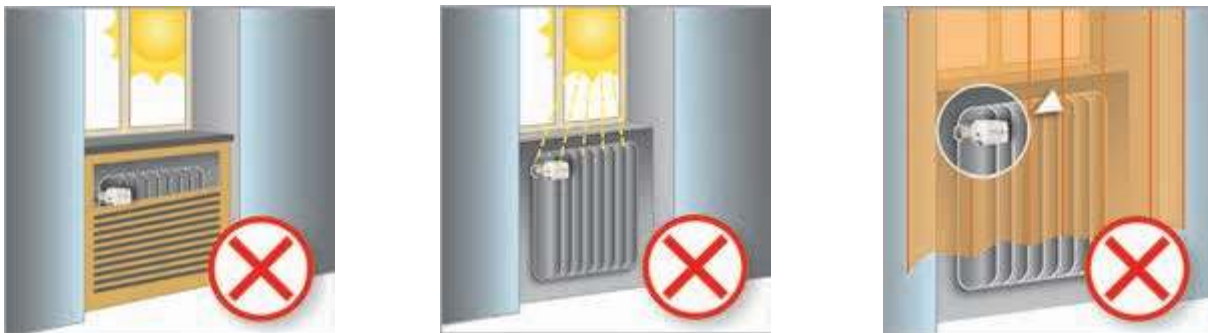
Рис. 8. Требования по размещению автоматического терморегулятора
