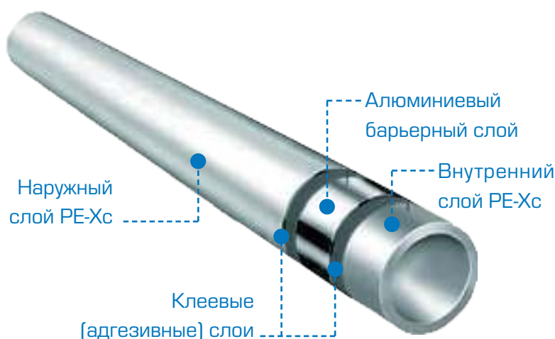
Рис. 2. Пятислойная труба PE-Xc/Al/PE-Xc
