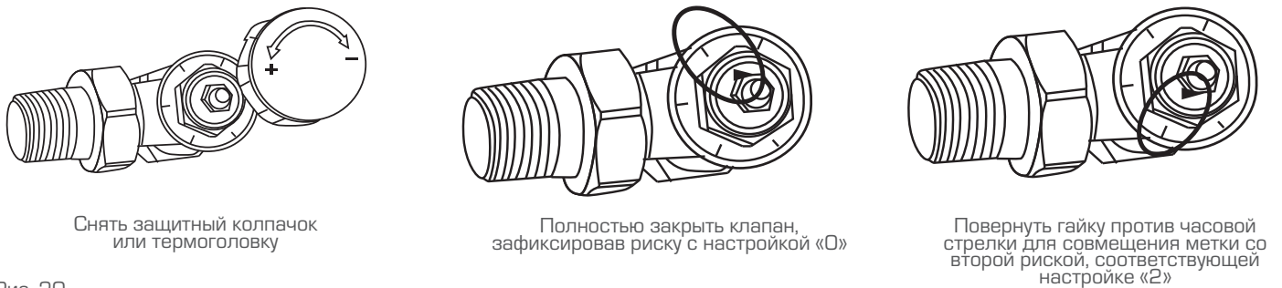
Рис. 20. Пример преднастройки клапана терморегулятора
