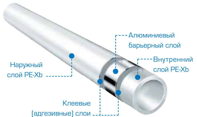
Рис. 5. Пятислойная металлополимерная труба PE-Xb/Al/PE-Xb
