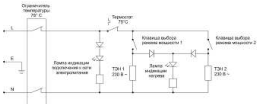
Рисунок 4. Схема электрических соединений
