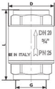
Рис. 29 Габаритные и присоединительные размеры обратного клапана с металлическим затвором
